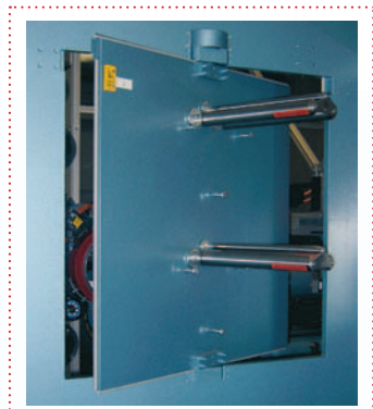
Servicestation: In- och utmatningsenhet för t.ex. manuell besiktning av skärstål
